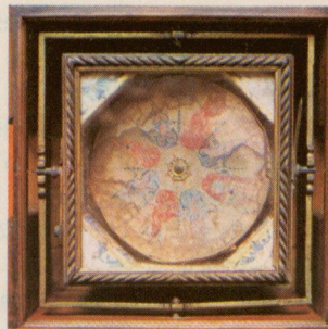
Vista de topo da agulha de marear, da Fragata "Niterói"
