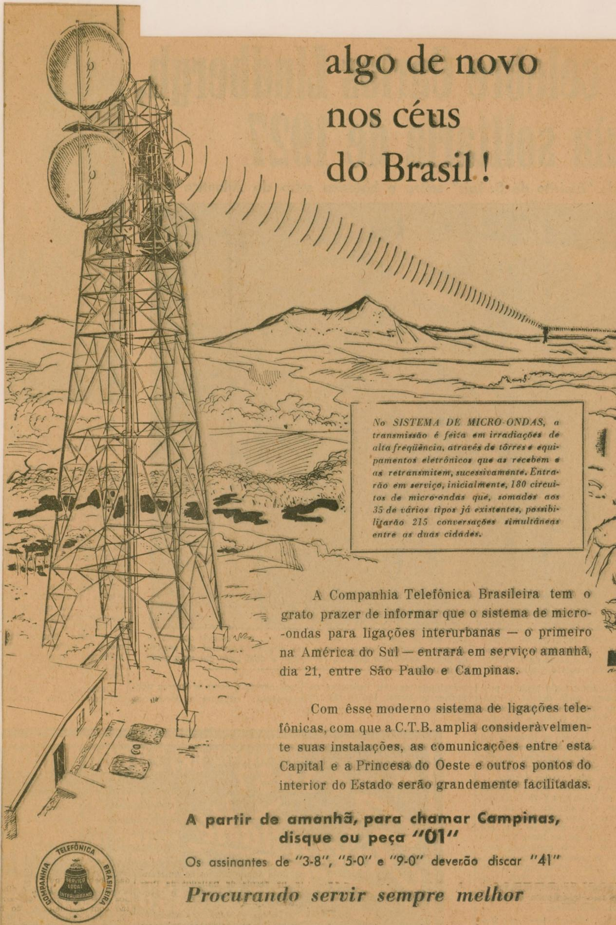
No SISTEMA DE MICRO-ONDAS, a transmissão é feita em irradiações de alta frequência, através de torres e equipamentos eletrônicos que as recebem e as retransmitem, sucessivamente. Entrarão em serviço, inicialmente, 180 circuitos de micro-ondas que, somados aos 35 de vários tipos já existentes, possibilitarão 215 conversações simultâneas entre as duas cidades.
