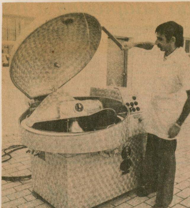
**TRITURADOR A VACUO** — Com dois movimentos, na bacia e quatro nas facas, o triturador Cutter oferece várias opções de emulsão.
